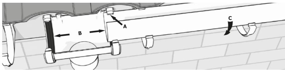
**5** Смонтируйте хомуты трубы на расстоянии не более 1000 мм друг от друга, при этом расстояние от края соединительных элементов трубы до ближайшего хомута не должно превышать 500 мм. Для крепления хомутов к стене используйте саморез либо шуруп-шпильку M6 достаточной длины.
